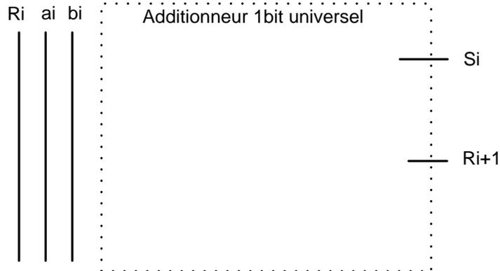
Rem : en réalisant 8 fois la même structure on réalise un additionneur 8bits
